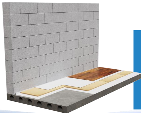
СХЕМА ШУМОИЗОЛЯЦИИ ПОЛА С ПРИМЕНЕНИЕМ ЗВУКОИЗОЛЯЦИОННЫХ ПАНЕЛЕЙ ТИС 14 Эффективно снижает ударный и акустический шум!
