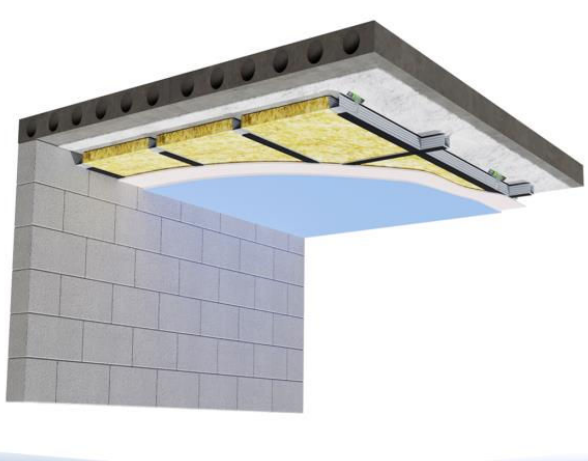
ШУМОИЗОЛЯЦИЯ ПОТОЛКА КАРКАСНАЯ СХЕМА Снижение ударных шумов от 50%
