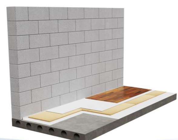
СХЕМА ШУМОИЗОЛЯЦИИ ПОЛА С ПРИМЕНЕНИЕМ ЗВУКОИЗОЛЯЦИОННЫХ ПАНЕЛЕЙ ТИС 14 Эффективно снижает ударный и акустический шум!
